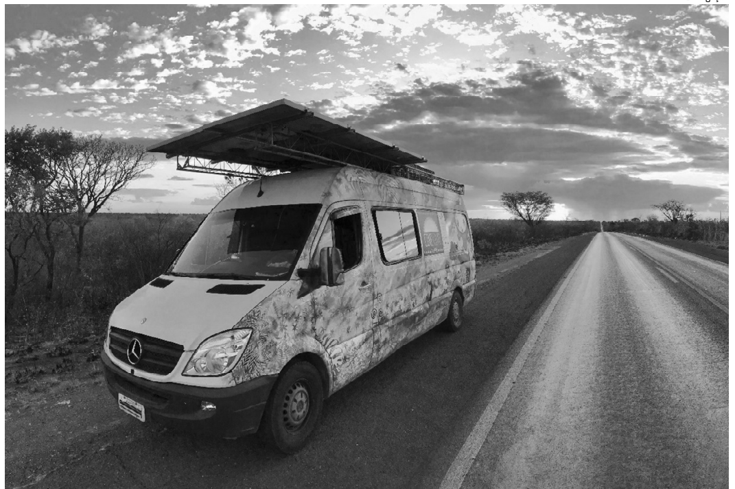
O furgão do CineSolar é adaptado com as placas fotovoltaicas no teto e carrega todo o cinema e armazenamento
